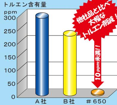
※テープ0.5gを秤量しDMF10mlを加え一昼夜浸させ、溶剤層を供試料としてガスクロマトグラフ法にて分析。
